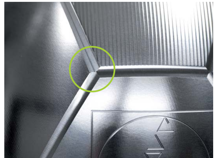
Closed Loop: Durch die präzisen Längen- und Winkelmessgeräte von HEIDENHAIN haben Fehler der Antriebsmechanik keinen Einfluss auf das Bearbeitungsergebnis. Die Naht wird in der richtigen Breite mit exaktem Verhalten an den Nahtübergängen gefräst.
