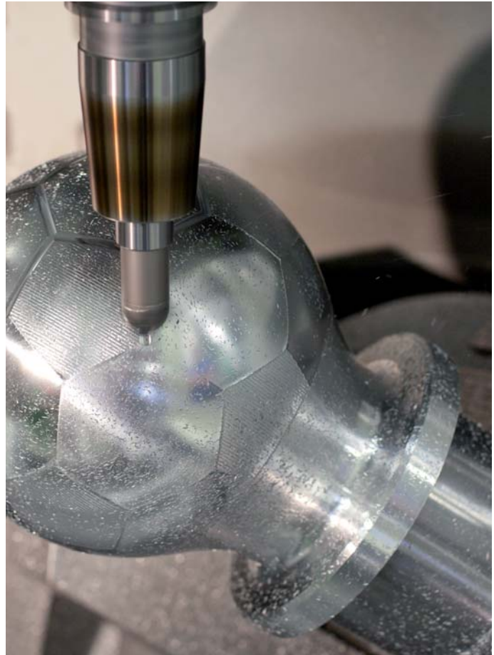
5-Achs-Fertigung des WM-Balls „Telstar“ von 1970 und 1974
