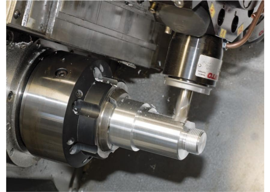
Fräsbearbeitung mit der Y-Achse an einer CNC-Drehmaschine
