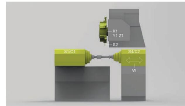
Komplettbearbeitung: Gegenspindel (S4) mit C-Achse (C2) auf Nebenachse (W) sowie ein angetriebenes Werkzeug (S2).
