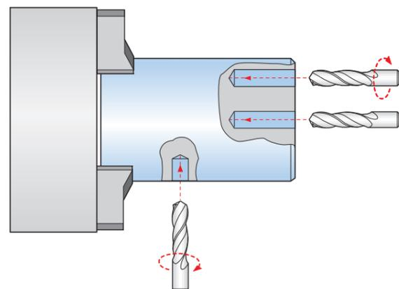
Bohren oder Gewindebohren
