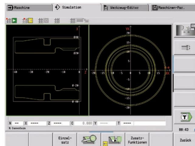
Grafische Konturprogrammierung für C-Achs-Bearbeitung (Bohren und Fräsen)
