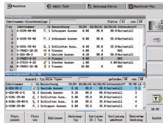
Werkzeugauswahl für Revolverbelegung
