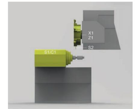
Spindel 1 (S1) mit C-Achse (C1) sowie angetriebenes Werkzeug (S2)
