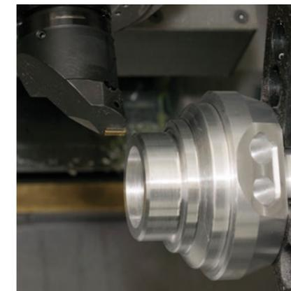
... Längsbearbeitung mit einem Werkzeug ...
