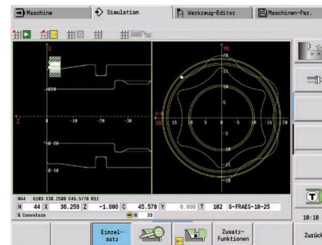
Rückseitenbearbeitung an der Gegenspindel nach automatischer Werkstückübergabe
