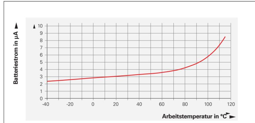
Typischer Entladestrom im Normalbetrieb ( $U_{BAT} = 3,6V$ )
