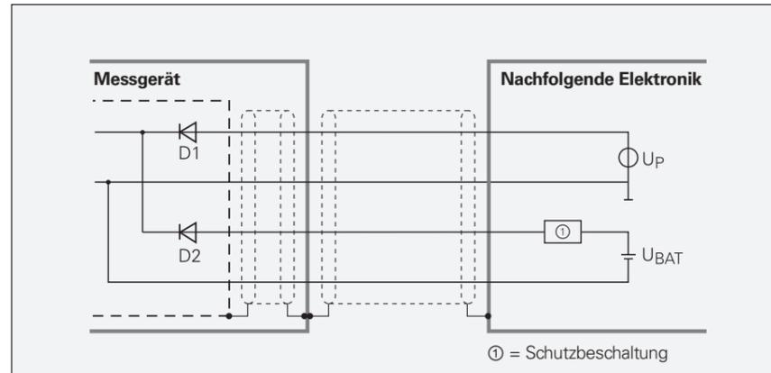
Anschluss der Pufferbatterie
