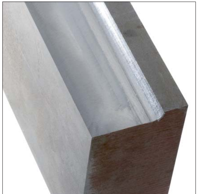
用ACC功能铣削的零件：相同进给速率和切削深度，表面无振纹。加工过程中刀具和机床负载减轻。
