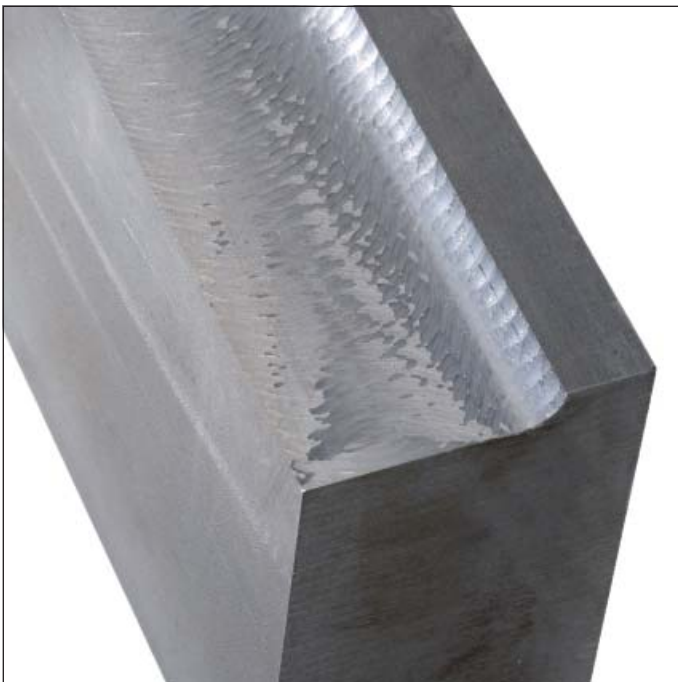
未用ACC功能铣削的零件：振纹明显可见。
