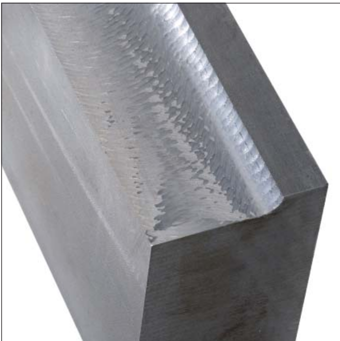
Součást frézovaná bez ACC: Stopy drnčení jsou jasně viditelné.
